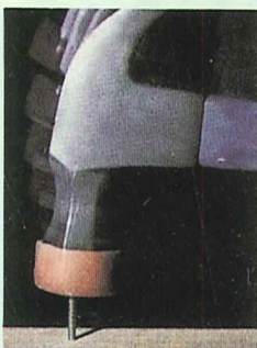
左：以12mm厚之Lucitone置於鐵釘上，並用鋼錘敲擊於2"×4"之木板上Lucitone未遭破壞
